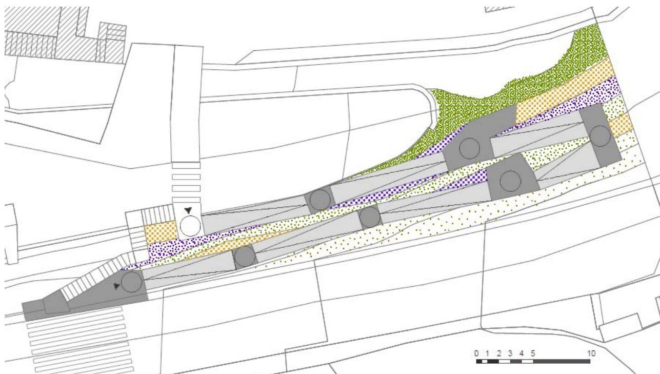
Croquis propuesta 2 de rampa de conexión entre la GC-293 y el Centro de Salud. Se plantea proyecto de adecuación paisajista del borde de la carretera creando zonas de estancia con mobiliario adaptado.
